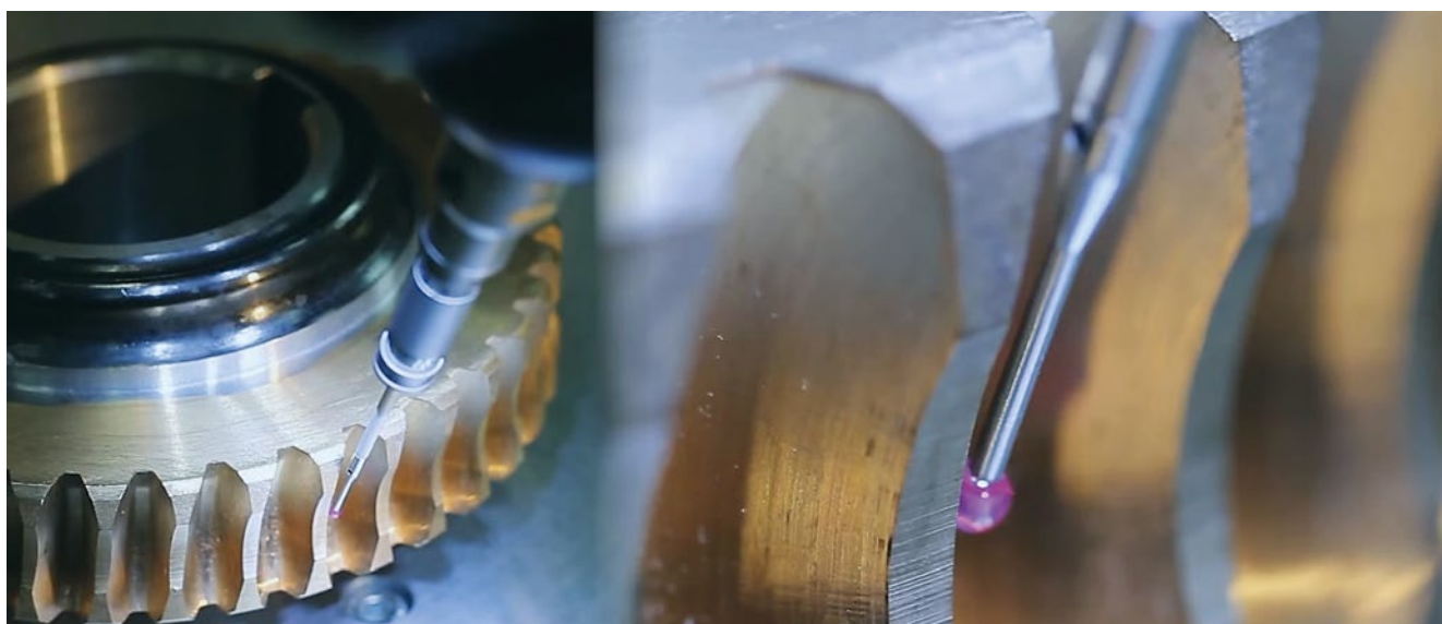
Измерение червячных зубчатых колес на КИМ
