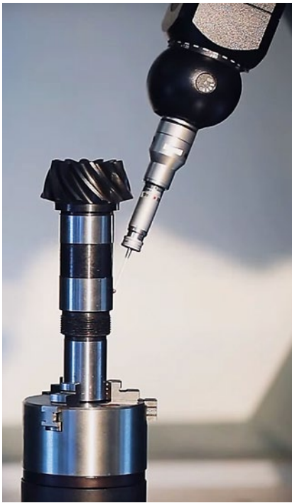
Измерение конического вала-шестерни с круговыми зубьями на КИМ «Лапик»
