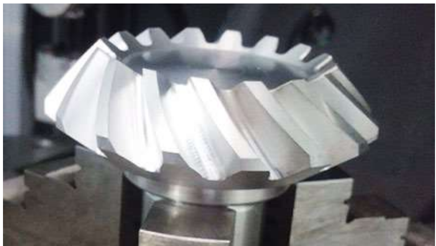
Элементы конической передачи с круговыми зубьями
