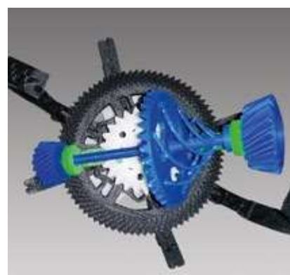
Прототип модели планетарного механизма с коническими зубчатыми колесами с круговыми зубьями в процессе сборки
