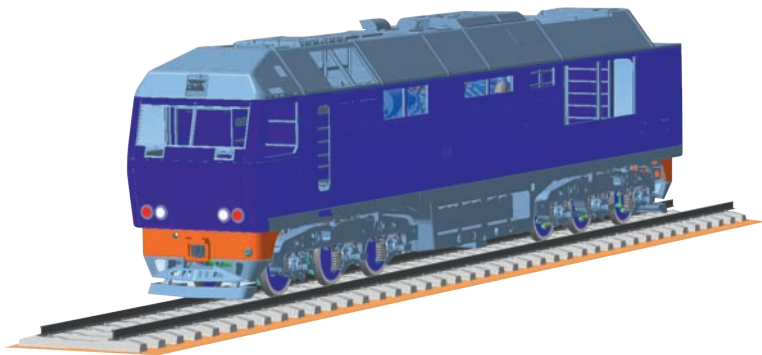
Рис. 8. Грузовой тепловоз 2ТЭ70, «Коломенский завод»
