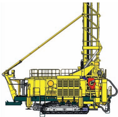
Рис. 9а. Станок буровой шарошечный СБШ-250-60, «УГМК-Рудгормаш»
