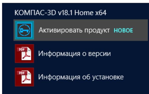
**ВНИМАНИЕ!** Перед началом активации проверьте корректность даты и времени на компьютере. Если системное время сбивается при каждом запуске компьютера, возможно нужно заменить батарейку на материнской плате.
