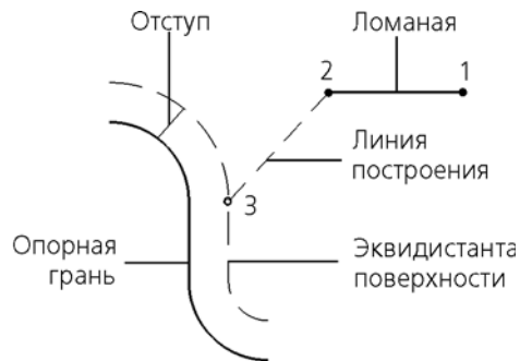
Рис. 2.5.29. Определение положения вершины путем задания ее смещения от опорной грани
