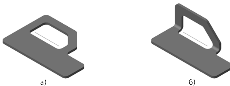
Рис. 2.4.44. Использование вспомогательной оси в качестве линии сгиба: а) расположение оси, б) результат построения
