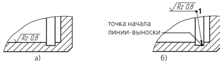
Рис. 3.3.47. Простановка обозначения шероховатости: а) без полки, б) на полке
