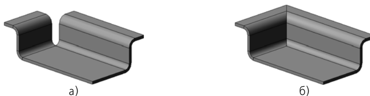
Рис. 2.4.70. Сгиб вдоль цепочки ребер: а) без замыкания углов, б) с замыканием (один из вариантов)
