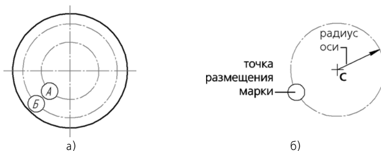
Рис. 3.3.127. Круговая координационная ось: а) пример использования, б) параметры оси
