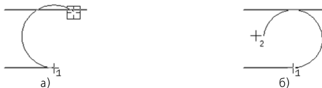
Рис. 3.2.67. Построение последующей дуги касательно к предыдущему сегменту и к произвольному объекту: а) выбор объекта, б) указание конечной точки
