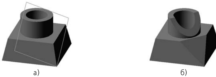
Рис. 2.3.51. Отсечение части детали плоскостью: а) исходное состояние детали (плоскость отсечения обозначена условно), б) результат выполнения операции отсечения
