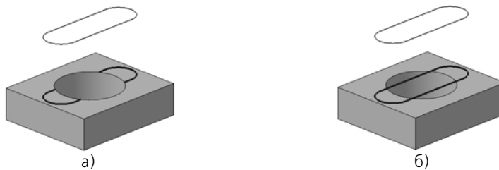
Рис. 2.5.60. Результат проецирования линии эскиза на грань с отверстием:
