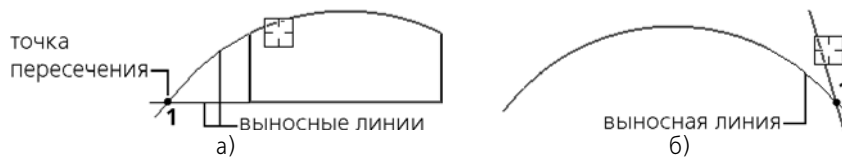
Рис. 3.3.96. Условное пересечение: а) для продолжений двух объектов; б) для объекта и продолжения другого объекта
