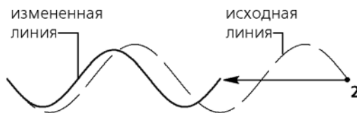
Рис. 3.3.91. Перемещение характерной точки t_2 при активных переключателях Длина волны и Значение амплитуды в %
