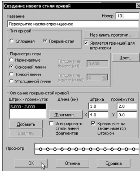
Рис. 10.1.19. Настройки стиля линии Перекрытие маслонепроницаемое
