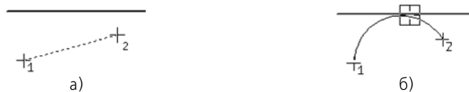
Рис. 3.2.65. Построение первой дуги линии касательно к объекту: а) указание начальной и конечной точек, б) указание объекта
