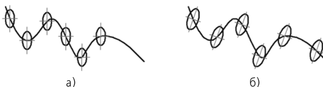
Рис. 3.4.10. Копирование объектов: а) с сохранением угла поворота и масштаба, б) с изменением угла поворота и масштаба
