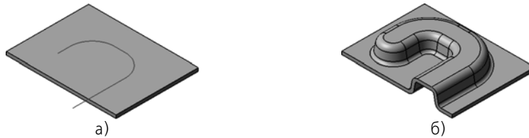
Рис. 2.4.104. Буртик, не уместающийся в пределах базовой грани: а) эскиз буртика; б) результат построения
