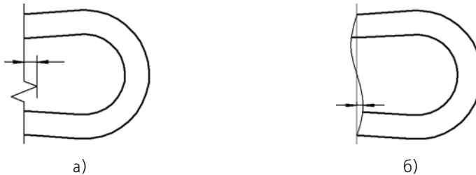
Рис. 3.5.18. Амплитуда: а) линии с изломом, б) волнистой линии (на рисунке также показана средняя линия)
