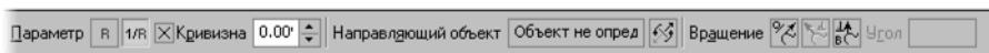
Рис. 2.5.34. Панель свойств при управлении ориентацией нормали и кривизной На экране появляется управляющий фантом (рис. 2.5.35).
