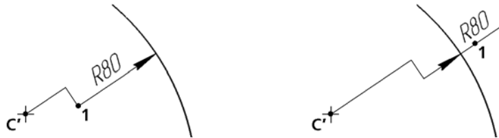
Рис. 3.3.29. Радиальные размеры с изломом с автоматически размещенной надписью
