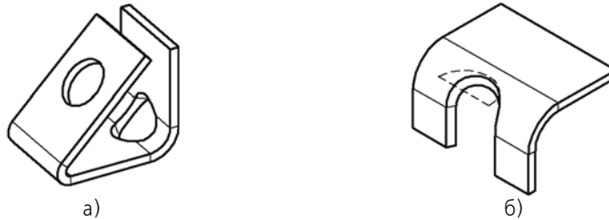
Рис. 2.4.92. Примеры отверстия и выреза, делающих невозможным разгибание сгиба: а) круглое отверстие, построенное способом На глубину , б) вырез, построенный способом До грани (эскиз выреза, расположенный на верхней плоской грани тела, показан штриховой линией)
