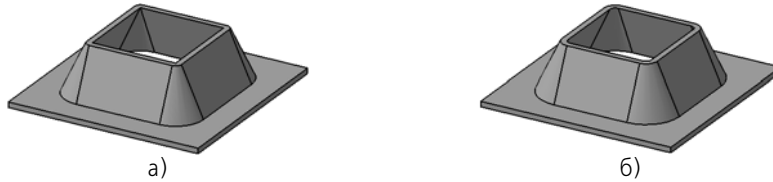
Рис. 2.4.100. Открытая штамповка с уклоном боковых стенок и скругленными боковыми ребрами: а) радиус скругления равен нулю, б) радиус скругления больше нуля
