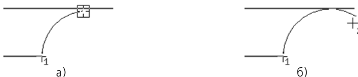
Рис. 3.2.70. Дуга по нормали, касательная к объекту: а) выбор объекта, б) указание конечной точки дуги
