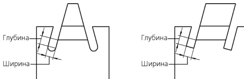
Рис. 2.4.41. Определение размеров освобождения сгиба при отличном от нуля угле на сгибе
