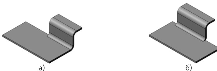
Рис. 2.4.67. Сгиб На расстояние : а) в одном направлении от плоскости эскиза, б) в двух направлениях
