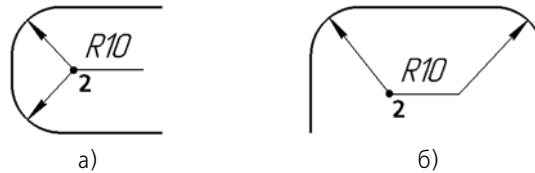
Рис. 3.3.27. Радиальный размер на полке с ответвлением: а) от начала полки, б) от конца полки.
