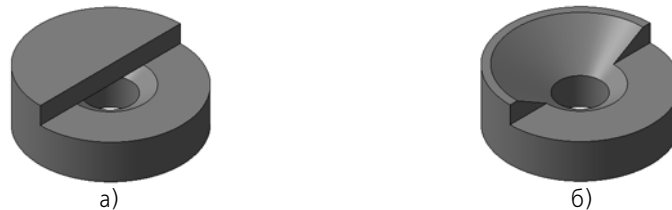
Рис. 2.3.56. Построение отверстия с зенковкой: а) опция Обрабатывать навес отключена; б) опция Обрабатывать навес включена
