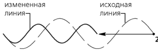
Рис. 3.3.90. Перемещение характерной точки t_2 при активных переключателях Количество полувольт и Значение амплитуды в %
