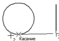
Рис. 3.2.63. Пример построения последующего отрезка линии
