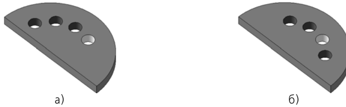
Рис. 2.7.28. Изменение положения экземпляров в массиве относительно базового экземпляра (базовый экземпляр показан белым цветом): а) базовый экземпляр с номером (1,1); б) базовый экземпляр с номером (1,2)
