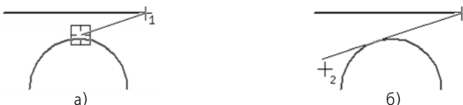
Рис. 3.2.62. Построение последующего отрезка линии касательно к другому объекту: а) указание объекта, б) указание конечной точки отрезка
