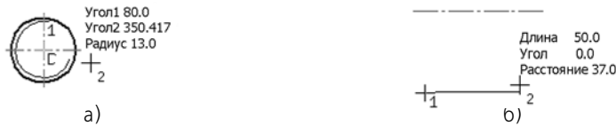
Рис. 1.4.8. Отображение параметров объектов рядом с курсором: а) при построении дуги по трем точкам, б) при построении отрезка, параллельного данному
