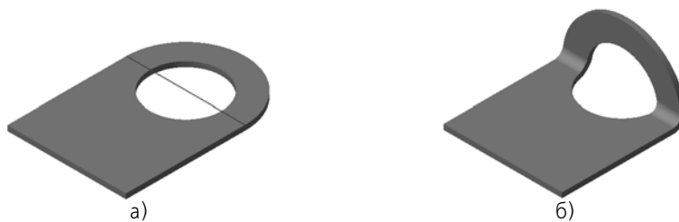
Рис. 2.4.43. Сгиб детали с отверстием: а) положение линии сгиба, б) результат построения
