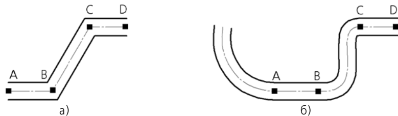
Рис. 3.2.77. Добавление сегментов в мультилинию: а) первоначальная мультилиния; б) результат добавления
