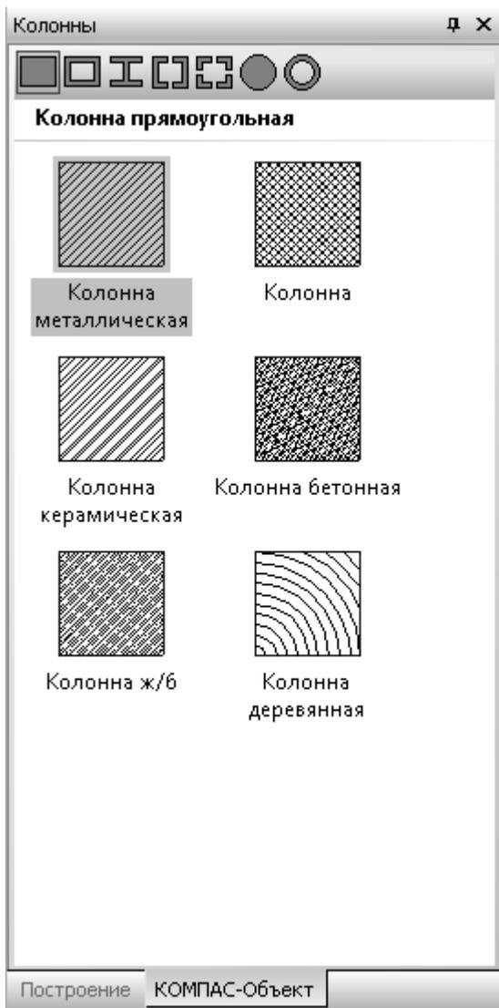
Панель включает в себя стандартный **КОМПАС-объект** с перечнем видов колонн в сечении, доступных для установки в чертеж.
