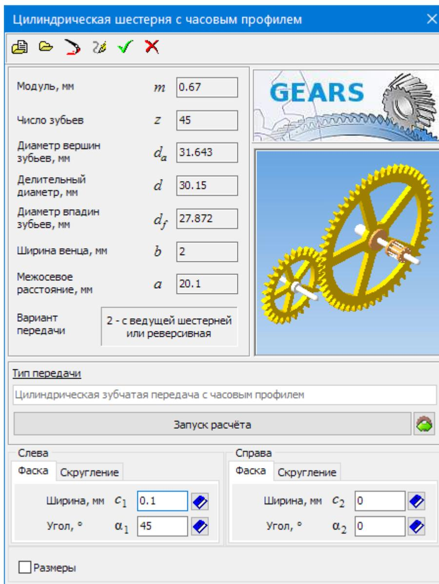
**Цилиндрическая шестерня с часовым профилем**
