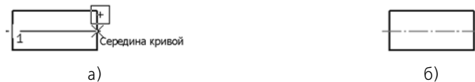
Рис. 3.3.80. Построение осевой линии по двум точкам: а) указание точек с использованием привязки, б) результат построения
