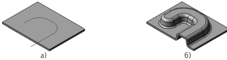
Рис. 2.4.113. Буртик, не уместающийся в пределах базовой грани: а) эскиз буртика; б) результат построения
