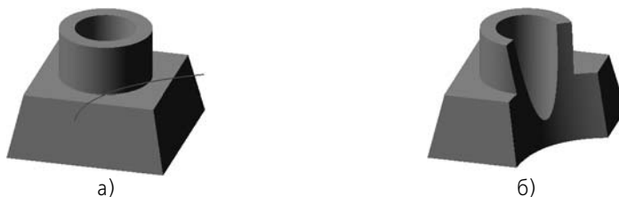
Рис. 2.3.52. Отсечение части детали по эскизу: а) исходное состояние детали, показан эскиз поверхности отсечения, б) результат выполнения операции отсечения
