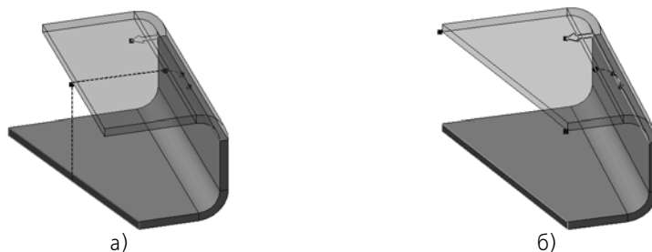
Рис. 2.4.38. Формирование продолжения сгиба способом До поверхности :
