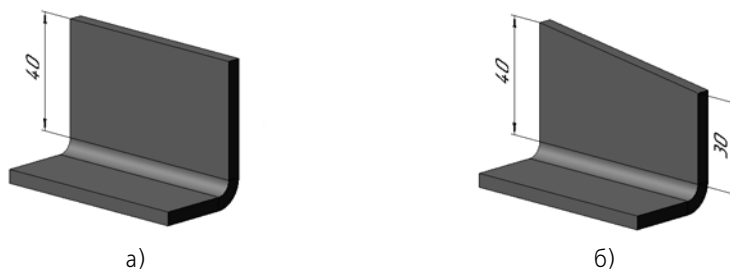
Рис. 2.4.37. Варианты формирования продолжения сгиба: а) опция По 2 сторонам отключена; б) опция По 2 сторонам включена
