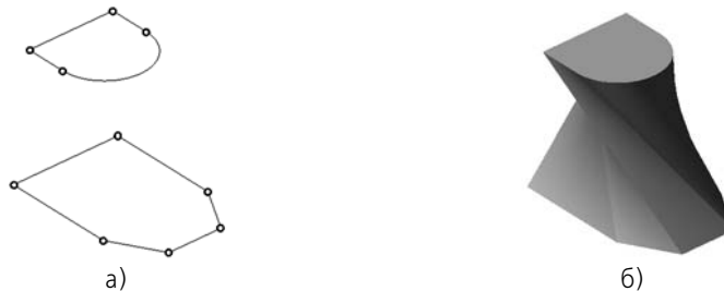
Рис. 2.3.36. Автоматическое соединение сечений с разной топологией
