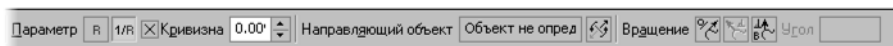
Рис. 2.5.27. Панель свойств при управлении ориентацией нормали и кривизной На экране появляется управляющий фантом (рис. 2.5.28).
