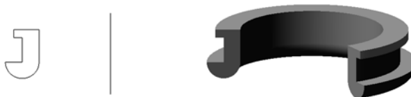
Рис. 2.3.22. Эскиз, ось и элемент, образованный операцией вращения
