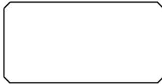
Рис. 3.2.99. Построение фасок на всех углах прямоугольника
