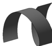
Рис. 2.6.4. Поверхность выдавливания с сечением-спиралью
