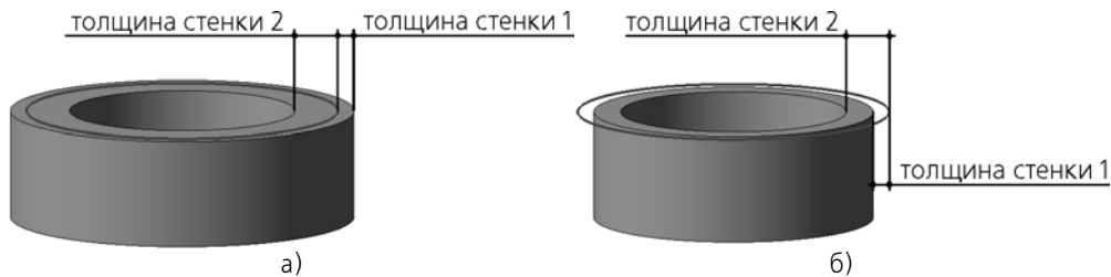
Рис. 2.3.16. Построение тонкой стенки в двух направлениях (на примере элемента выдавливания; сечение показано утолщенной линией): а) толщина стенки 1 и толщина стенки 2 положительные; б) толщина стенки 2 не изменилась, а толщина стенки 1 получила противоположный знак
