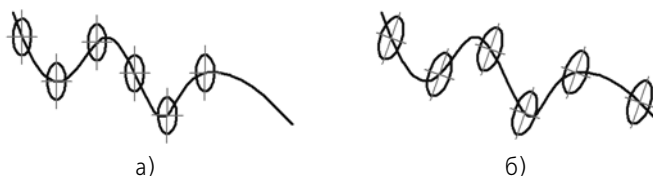
Рис. 3.5.10. Копирование объектов: а) с сохранением угла поворота и масштаба, б) с изменением угла поворота и масштаба
