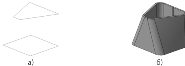
Рис. 2.4.24. Построение линейчатой обечайки на основе замкнутых контуров: а) эскизы оснований; б) линейчатая обечайка
