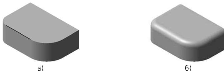
Рис. 2.3.43. Скругление: а) для построения скругления указано одно ребро и включена опция Продолжать по касательной , б) результат построения скругления
