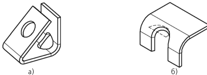
Рис. 2.4.101. Примеры отверстия и выреза, делающих невозможным разгибание сгиба: а) круглое отверстие, построенное способом На глубину , б) вырез, построенный способом До грани (эскиз выреза, расположенный на верхней плоской грани тела, показан штриховой линией)
