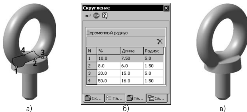
Рис. 2.3.44. Построение скругления с переменным радиусом: а) указание точек, б) задание параметров скругления, в) результат выполнения команды
