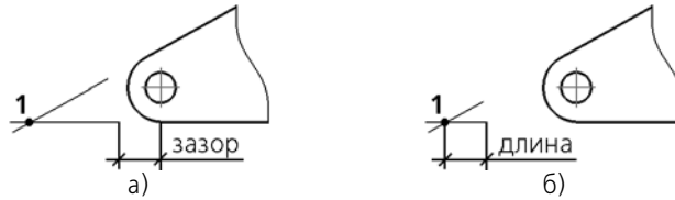
Рис. 3.3.101. Отрисовка выносных линий при задании ненулевого значения: а) зазора; б) длины
