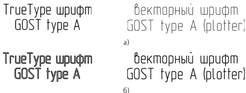
Рис. 3.5.24. Преобразование текстов в NURBS: а) исходные объекты — тексты, набранные TrueType-шрифтом и векторным шрифтом, б) результаты преобразования
