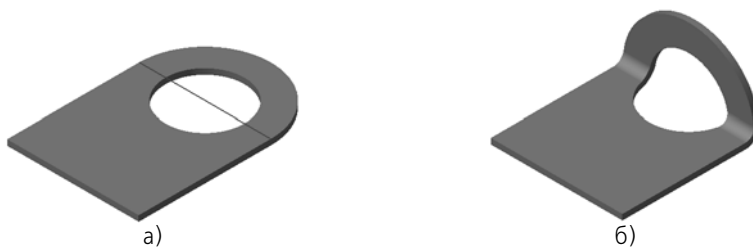
Рис. 2.4.49. Сгиб детали с отверстием: а) положение линии сгиба, б) результат построения
