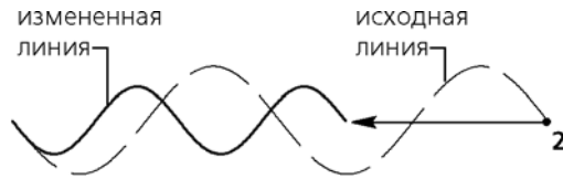
Рис. 3.3.94. Перемещение характерной точки t_2 при активных переключателях Количество полувольт и Значение амплитуды в %
