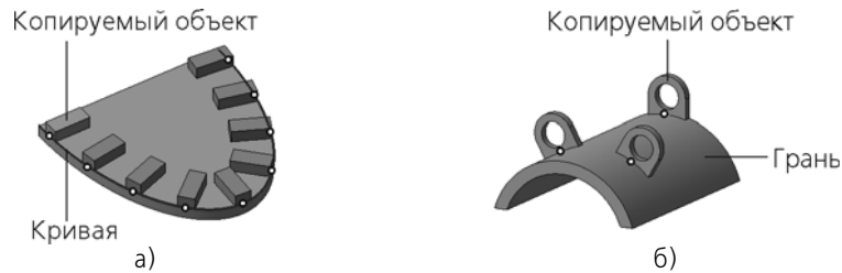
Рис. 2.7.37. Пример расположения экземпляров массива: а) с ориентацией по кривой; б) с ориентацией по поверхности
