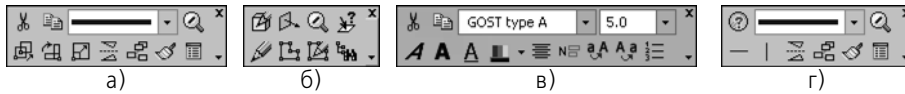
Рис. 1.2.10. Контекстная панель при выделении: а) геометрического объекта в чертеже или фрагменте, б) грани тела в сборке, в) фрагмента текста в текстовом документе, г) геометрического объекта в эскизе трехмерного элемента
