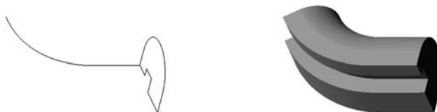
Рис. 2.3.30. Сечение, направляющая и кинематический элемент
