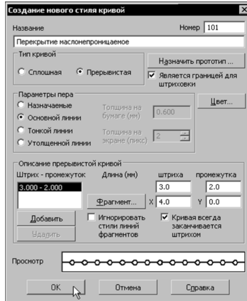
Рис. 11.1.19. Настройки стиля линии Перекрытие маслoneпроницаемое
