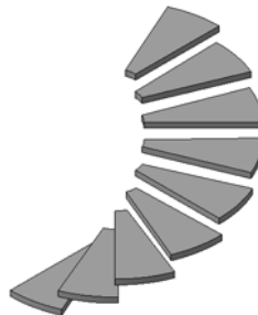
Рис. 2.7.26. Пример массива по концентрической сетке со сдвигом экземпляров вдоль оси
