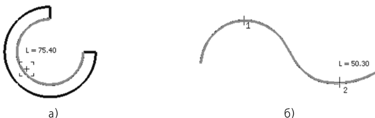
Рис. 3.9.2. Просмотр результатов измерения: а) длина кривой; б) расстояние между двумя точками на кривой
