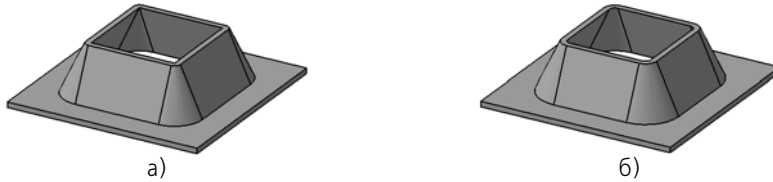
Рис. 2.4.109. Открытая штамповка с уклоном боковых стенок и скругленными боковыми ребрами: а) радиус скругления равен нулю, б) радиус скругления больше нуля
