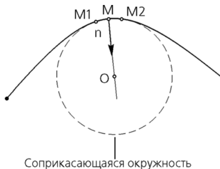
Рис. 7. Соприкасающаяся окружность в точке M кривой
