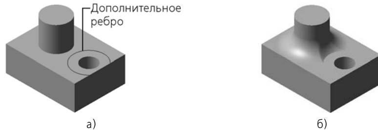
Рис. 2.6.32. Использование ребра, полученного разбиением грани: а) исходное состояние детали, б) результат построения скругления с сохранением кромки
