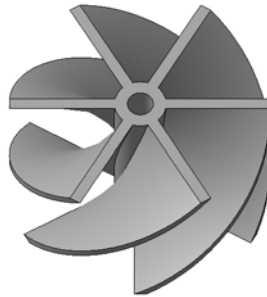
Рис. 2.7.23. Пример массива по концентрической сетке
