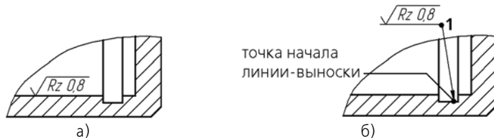
Рис. 3.3.51. Простановка обозначения шероховатости: а) без полки, б) на полке
