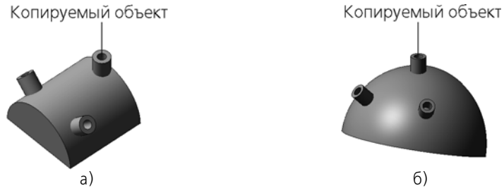
Рис. 2.7.45. Пример ориентации экземпляров массива по радиальному направлению: а) позиции заданы в цилиндрических координатах; б) позиции заданы в сферических координатах
