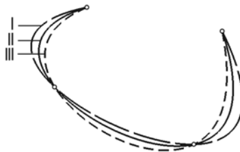
Рис. 3.2.52. Сплайны с разными способами формирования параметров точек: I – Линейный , II – Центростремительный , III – По длине хорды
