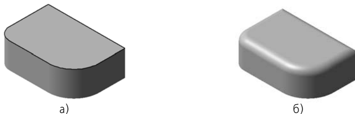
Рис. 2.3.42. Скругление: а) для построения скругления указана верхняя грань, б) результат построения скругления
