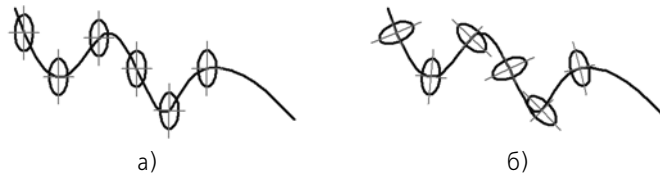
Рис. 3.5.13. Копирование эллипса вдоль сплайна: а) без доворота копий до нормали, б) с доворотом копий до нормали
