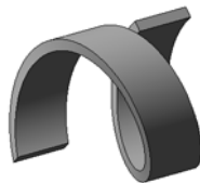
Рис. 2.3.6. Элемент выдавливания с сечением-спиралью
