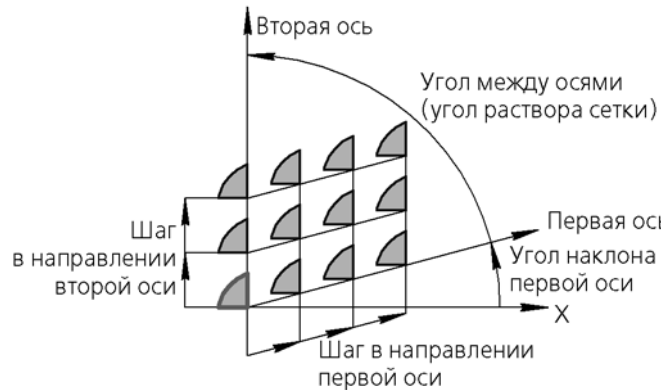
Рис. 2.7.21. Схема образования параллелограммной сетки
