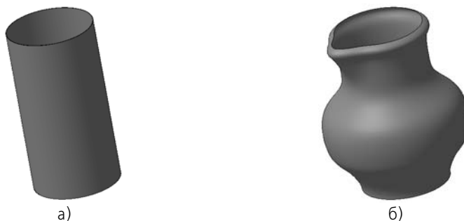
Рис. 2.6.37. Произвольное редактирование грани: а) исходное состояние грани, б) результат редактирования
