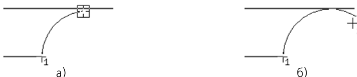
Рис. 3.2.72. Дуга по нормали, касательная к объекту: а) выбор объекта, б) указание конечной точки дуги
