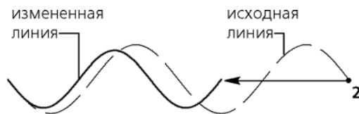
Рис. 3.3.95. Перемещение характерной точки t_2 при активных переключателях Длина волны и Значение амплитуды в %
