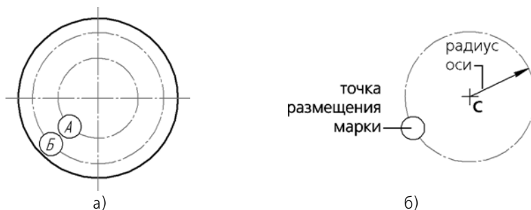
Рис. 3.3.131. Круговая координационная ось: а) пример использования, б) параметры оси
