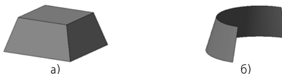
Рис. 2.6.3. Уклон боковых граней поверхности выдавливания: а) замкнутой, б) незамкнутой
