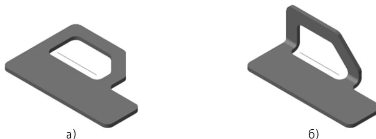
Рис. 2.4.50. Использование вспомогательной оси в качестве линии сгиба: а) расположение оси, б) результат построения
