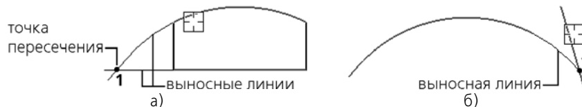
Рис. 3.3.100. Условное пересечение: а) для продолжений двух объектов; б) для объекта и продолжения другого объекта
