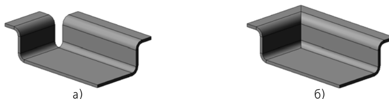
Рис. 2.4.79. Сгиб вдоль цепочки ребер: а) без замыкания углов, б) с замыканием (один из вариантов)
