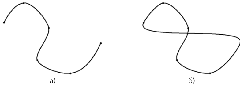
Рис. 3.2.51. Кривая Безье: а) разомкнутая, б) замкнутая
