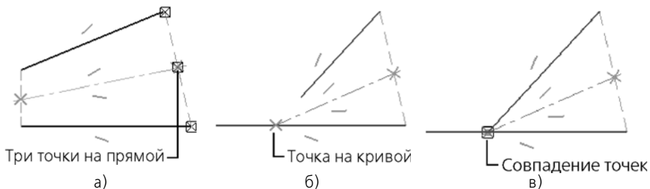
Рис. 7.2.6. Ограничения, наложенные на автоосевую при различном расположении отрезков
