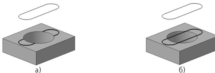
Рис. 2.5.53. Результат проецирования линии эскиза на грань с отверстием:
