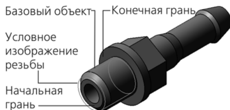
Рис. 2.9.26. Условное изображение резьбы в детали Ниппель
