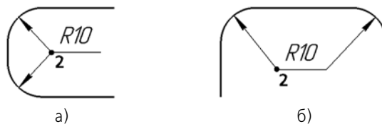
Рис. 3.3.28. Радиальный размер на полке с ответвлением: а) от начала полки, б) от конца полки.
