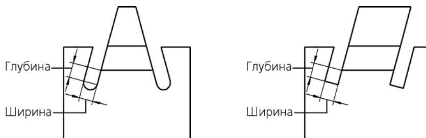
Рис. 2.4.47. Определение размеров освобождения сгиба при отличном от нуля угле на сгибе
