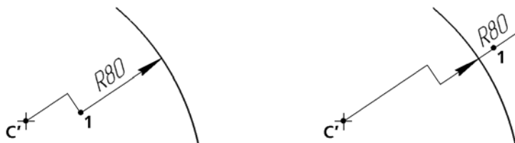
Рис. 3.3.30. Радиальные размеры с изломом с автоматически размещенной надписью
