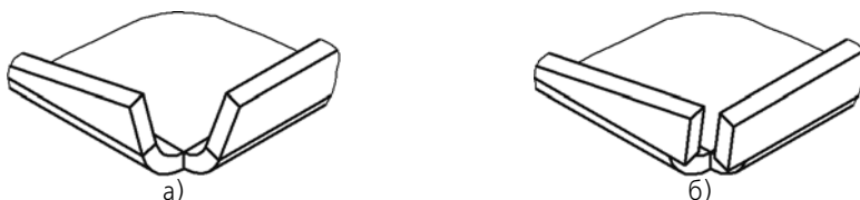
Рис. 2.4.63. Замыкание встык: а) исходное состояние детали, б) результат замыкания угла (зазор отличен от нуля)
