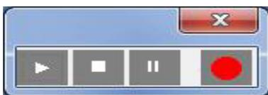
Если в настройках системы установлена опция **Создать видеоролик**, или перед нажатием кнопки **Пуск** нажать кнопку **Создать видеоролик**, то при запуске воспроизведения начнется параллельная запись ролика в формате AVI. По окончании воспроизведения система предлагает выбрать место на диске для сохранения видеофайла и его имени.
