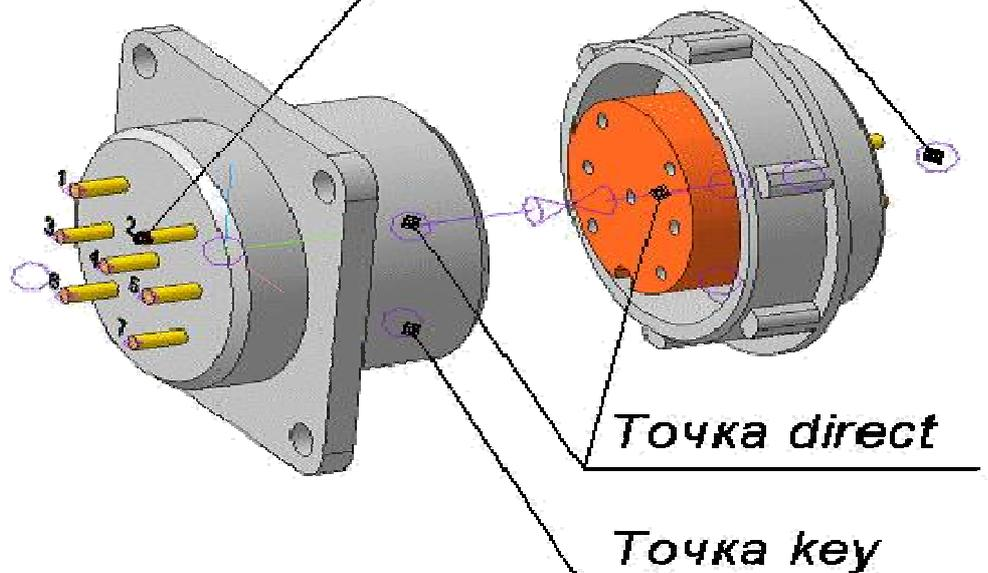
Ж) В точке начала координат модели соединителя необходимо разместить контрольную точку с именем **Component**. В точке начала координат модели блока (прибора) необходимо разместить контрольную точку с именем **Block**.
