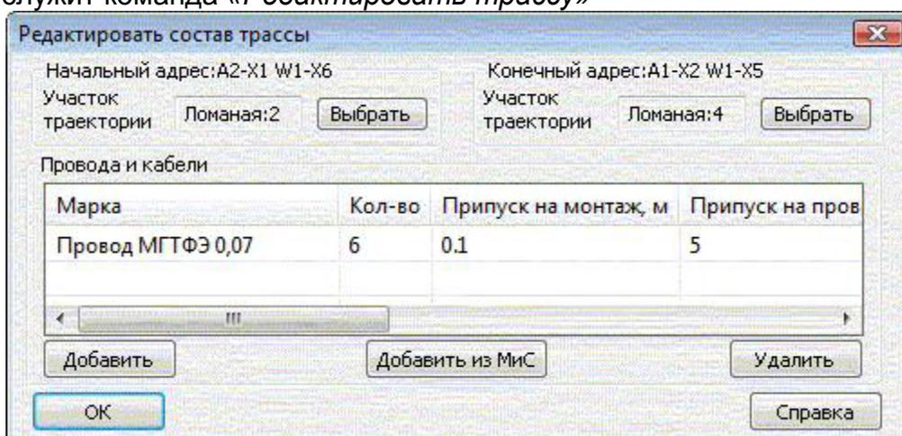
В полях *Начальный адрес* и *Конечный адрес* отображаются соответствующие адреса электрического соединения (БЦО блочных и кабельных частей разъемов).
