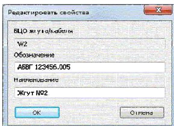
Модели соединителей, входящих в состав жгута (кабеля), необходимо размещать в подборке этого жгута (кабеля) с помощью команды КОМПАС-3D «Добавить из файла» в режиме «Редактировать в окне».
